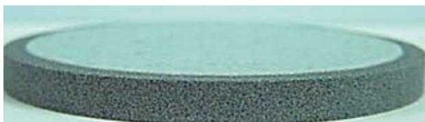
Рис. 3. Фильтрационная корка временно блокирующего состава на поверхности пористой среды
