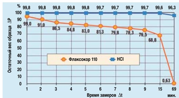
**Рис. 1. Динамика убыли веса образца корки глинистого бурового раствора при использовании ФЛАКСОКОР 110**
