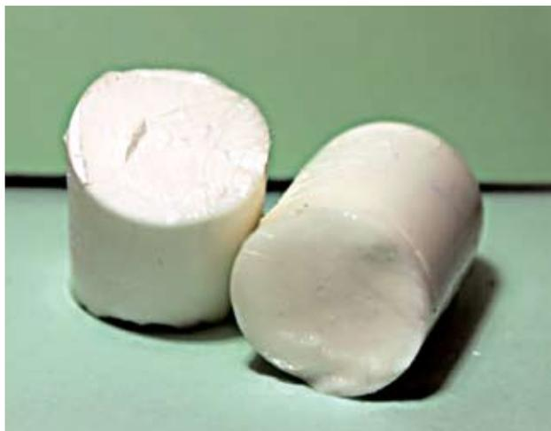
Рис. 6. Отвержденная тампонажная масса состава Карболекс
