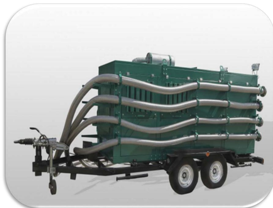
Станция АСОТ 100x25 - мобильная. При ее использовании гидроиспытания подающей и обратной трубы производятся отдельно. Сети каждого района разбиваются на участки. На каждый участок составляется график опрессовки. Испытания можно проводить на участках любой протяженности, а время испытаний сокращается до минимума.
